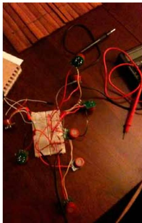
测量空气质量的小东西构造并不复杂，由传感器、微型芯片、电池和LED灯组成
